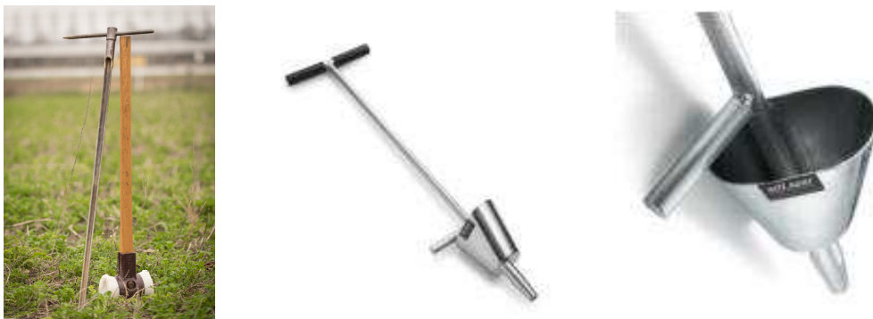
Abbildung 2: Schlagbohrer (R. Körner); Schüsserlbohrer zur Beprobung von Grünlandflächen (Quelle:Fa. Ertl-Auer)
